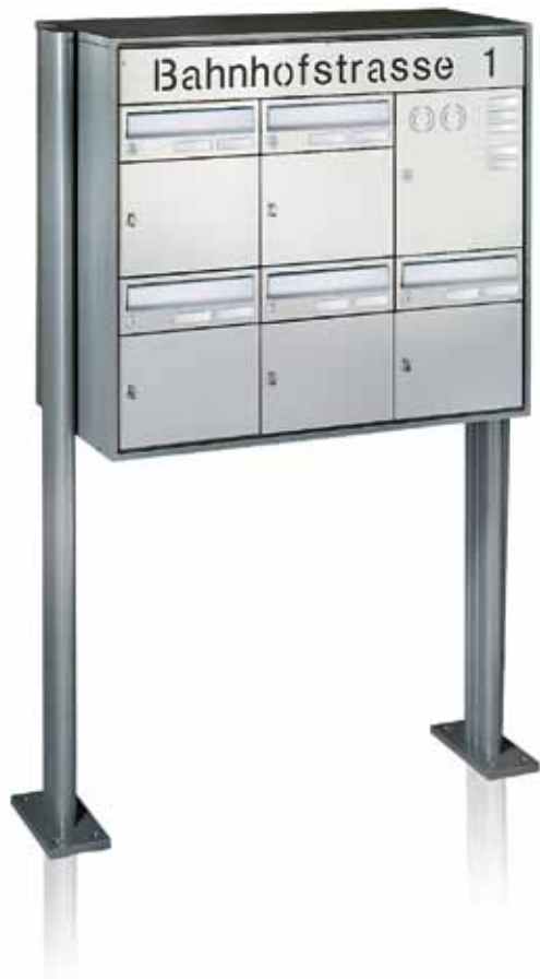
Abb. 5 Briefkastenanlage Typ 38 mit Edelstahltüren, QUADRA-Verkleidung und ALU-Ovalrohrständer 105 x 45 mm pulverbeschichtet, mit Antivandalismus-System RSA2 , Beschriftungskasten mit Durchgravur.
